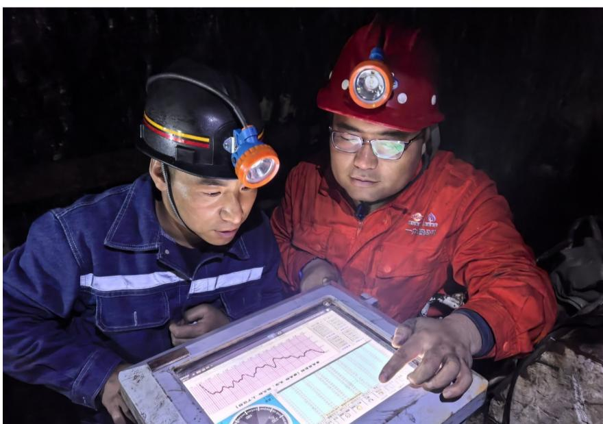
探工程，预探测矿区地质构造、含水体分布等关键信息，提前研判水害风险点，为矿井掘进作业规划安全路径。此外，公司严格遵守井下探放水安全规程，高效推进并圆满完成了内蒙古淖尔壕煤矿工作面井下探放水，榆林魏墙煤矿工作面顶板探放水，以及山东煤矿工作面回风顺槽异常积水区定向钻探技术工程。施工过程中，公司严格把控钻孔参数校准、异常情况处置、钻场规范化管理等关键环节，详实记录水量、水压等核心数据，确保探放水作业全程规范、高效、安全，从源头防范水害风险，保障矿井采掘作业安全有序推进。
